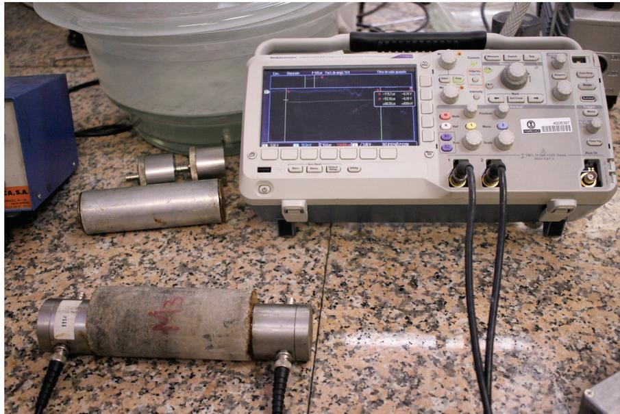
Fig. 3.—Determinación de la velocidad de propagación.
